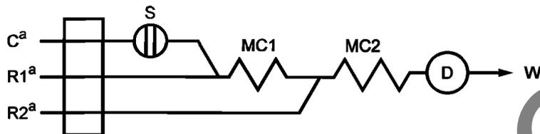
$C^a$  — трубка раствора-носителя;  $D$  — детектор с длиной волны 720 нм, с проточной кюветой с длиной оптического пути 1 см (объем 18 мкл);  $MC1$  — виток смешивания, длина 60 см, внутренний диаметр 0,7 мм;  $MC2$  — виток смешивания, длина 60 см, внутренний диаметр 0,7 мм;  $R1^a$  — линия раствора уксусной кислоты (5.5);  $R2^a$  — линия раствора йода (5.6);  $S$  — инжектор для ввода пробы, инжектируемый объем 300 мкл;  $W$  — емкость для отходов
