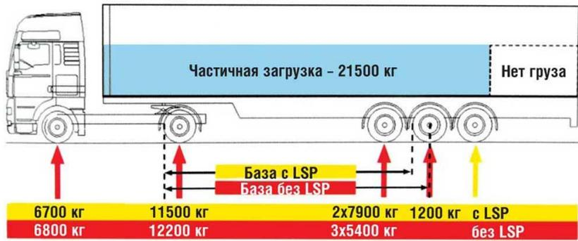
Схема работы системы Load Spread Programm (LSP) на примере автопоезда с неравномерной загрузкой. Желтым цветом помечена нагрузка на оси с использованием новой системы LSP, красным цветом – без применения LSP.
