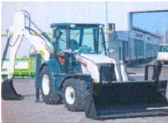
Рис.2. Экскаватор-погрузчик ТО-49
