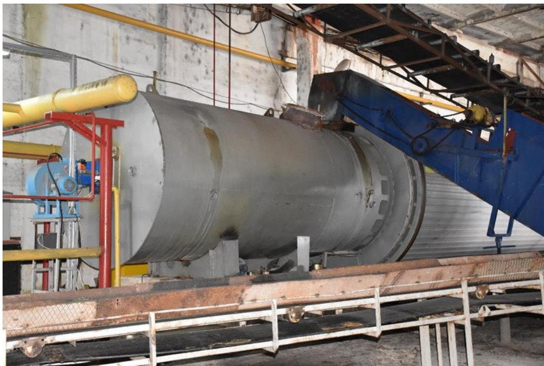
Сушилка газовая для сушки яблочной выжимки
